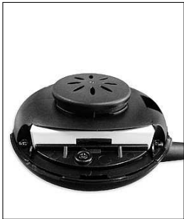
BATTERIA INSTALLATA NELL'AURICOLARE
